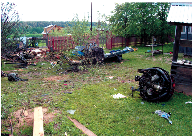
Рис. 1.5. Падение самолета: разброс элементов обшивки и двигателя от фюзеляжа
