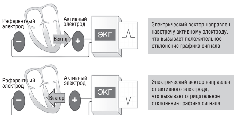
Рис. 1.1. Получение электрического сигнала ЭКГ с противоположными векторами
