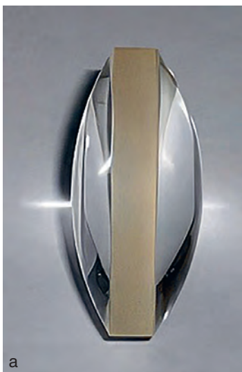
Рис. 1.30. Толстая двояковыпуклая линза (а) и схема прохождения луча через такую линзу (б): луч AF пересекает оптическую ось OO' в точке фокуса F. R_1 и R_2 — радиусы кривизны передней и задней поверхностей линзы; H и H' — главные плоскости линзы; d — толщина линзы; a и a' — расстояние от передней и задней главных плоскостей до соответствующих ее поверхностей; n_1 , n_2 , n_3 — коэффициент преломления сред по ходу следования луча AF
