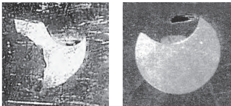
Рис. 4.4. Поперечные сечения образцов стали ЭП823 после коррозионных испытаний в свинце на границе хвостовик — конусная часть образца, T = 600 °С, \tau = 300 часов [66, 139]
