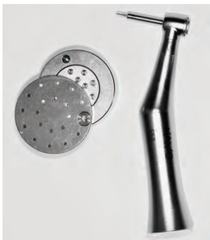
Рис. 1.3. Ударные пины и пинодержатель для фиксации мембраны
