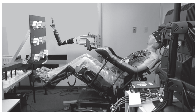
Рис. 7.9. Аппаратная система реабилитации — виртуальная реальность, создающаяся при помощи интерфейса мозг-компьютер: а — схема работы системы; б — парализованный участник исследования Тим Левицки управляет роботизированной рукой посредством мозга (фото с сайта UPMC HealthBeat)
