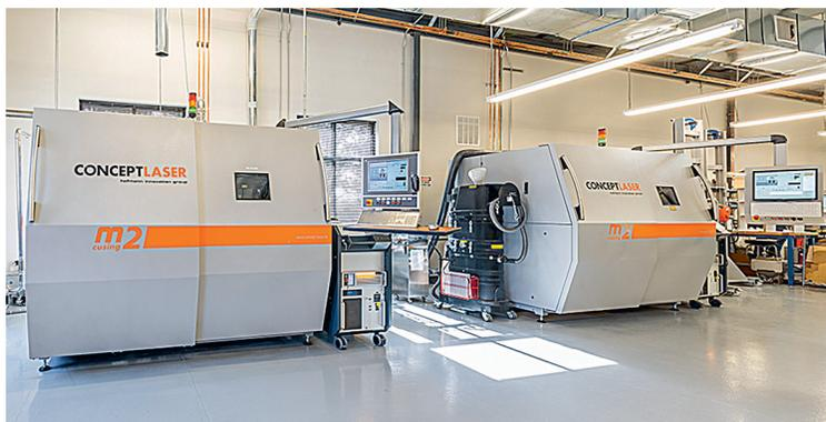
Рис. 1.7. Фотография SLS-3D-принтера (<https://3dtool.ru>)
