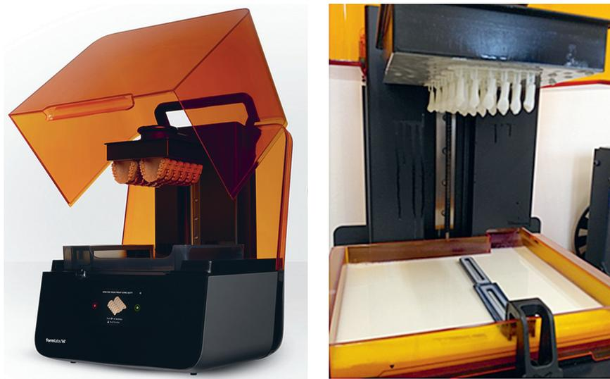
Рис. 1.4. SLA-3D-принтер
