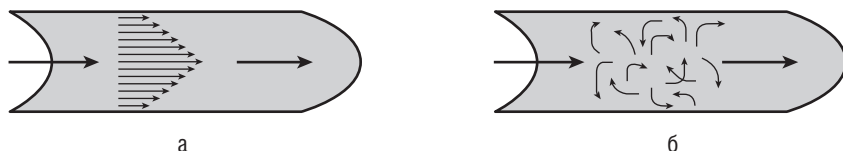
Рис. 3.5. Схема ламинарного (а) и турбулентного (б) течения жидкости
